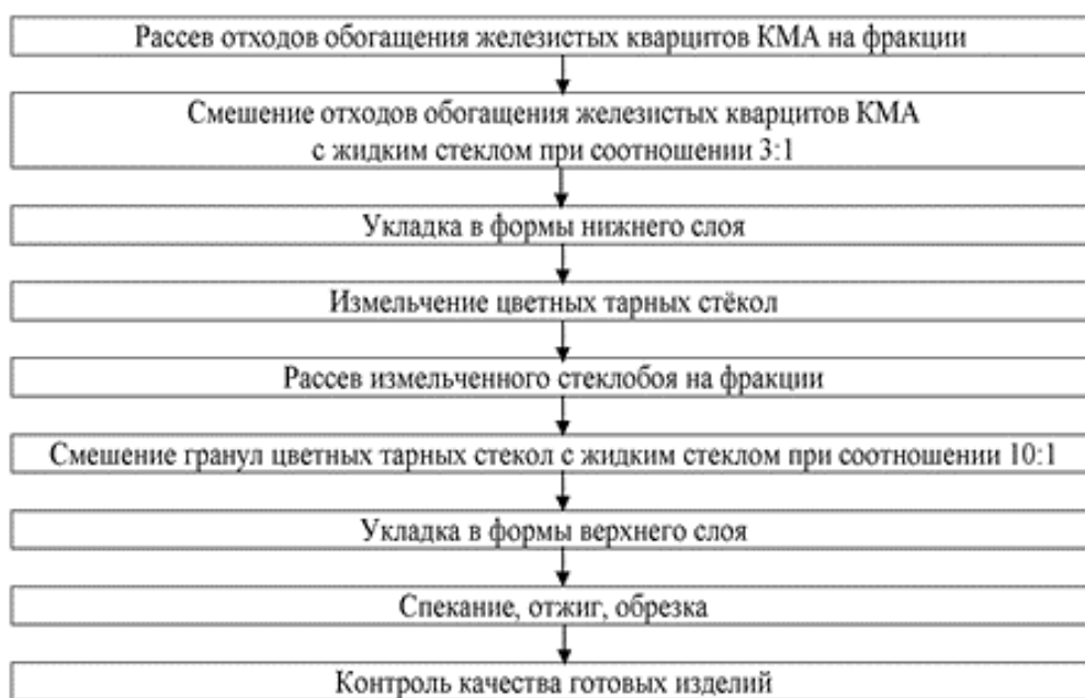
Рисунок 5.6 – Технологическая схема получения стеклокремнезита
