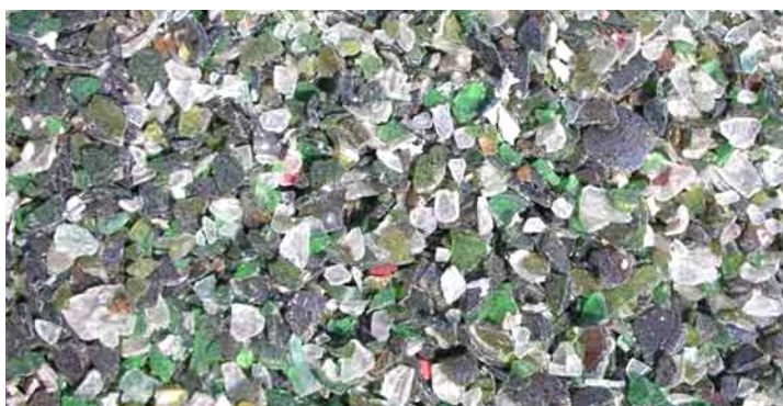
Рисунок 1.1 – Использованные стеклоизделия – вторичный стеклобой
